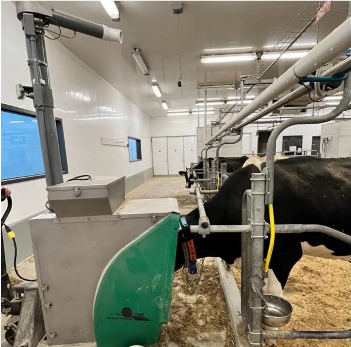
Figure 1. Système GreenFeed utilisé pour mesurer les flux de gaz, y compris le méthane provenant des animaux individuels.
