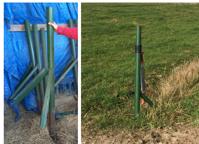
Figure 36. Poteaux de coin fabriqués à partir de tubes d'acier auxquels des renforts ont été soudés
